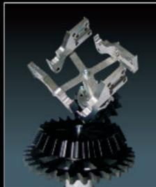
Werkstückhalter mit montierten Werkstücken auf Satellit aufgesteckt
