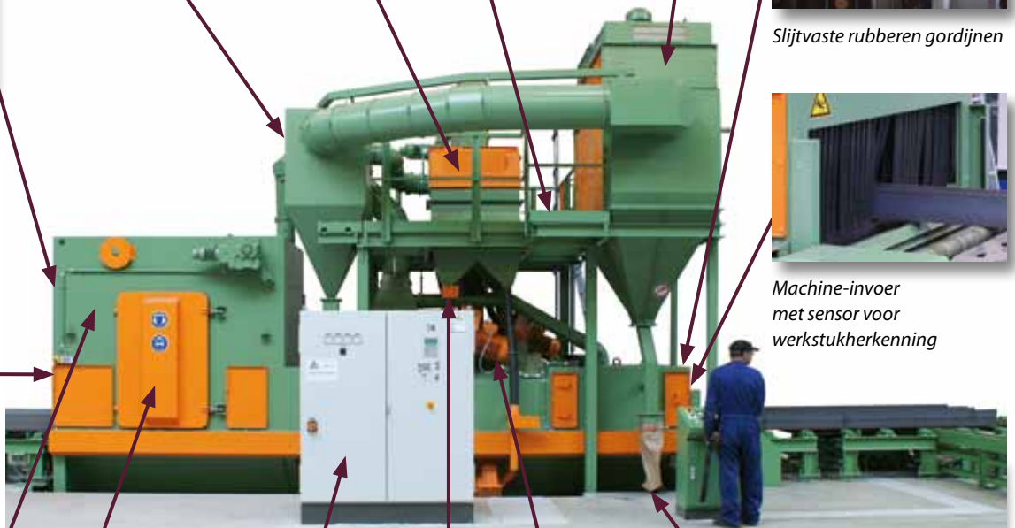
Staanste lagers van de transportrollen zijn buiten de machine geïnstalleerd
