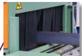
Machine-invoer met sensor voor werkstukherkenning
