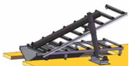
Kiepinrichting voor de straalmiddel-leging van buizen na het straalproces
