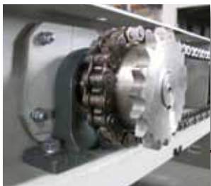
Staanste lagers van de transportrollen zijn buiten de machine geïnstalleerd
