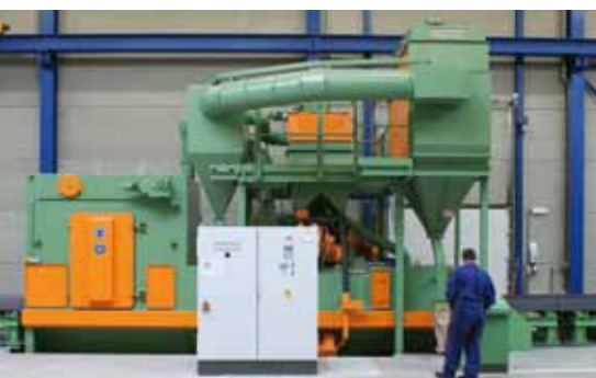
De AGTOS straalinstallatie met duidelijk gemarkeerde onderhoudsdeuren.
