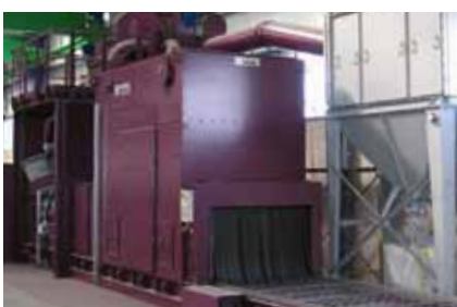
Straalinstallatie voor platen, profielen en constructies met doorloophoogte tot en met 1000 mm
