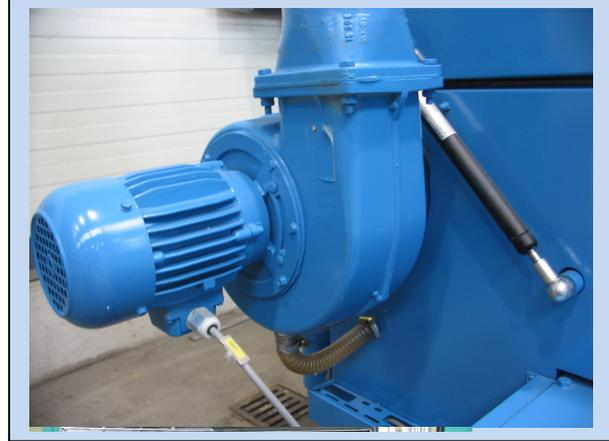
Bild 2: Dampfabsaugventilator D06
