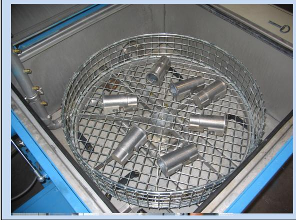
Bild 1: Waschkorb bestückt mit Aluminiumgehäuse
