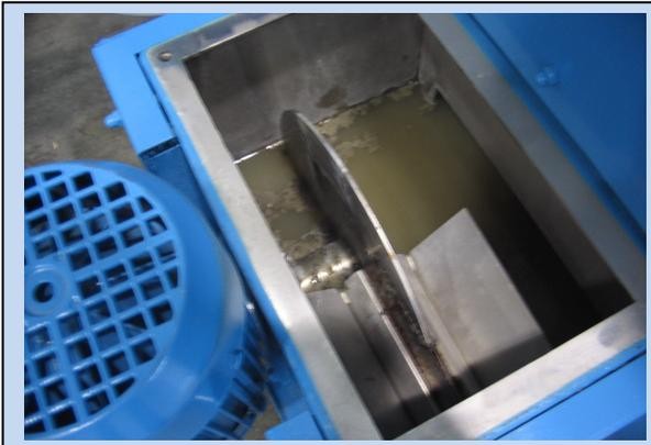
Bild 5: Ölabscheider / Ölskimmer
