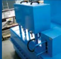
Öltrennung mittels Plattenphasentrenner
