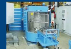
Die Reinigung erfolgt über einen auf Teilehöhe absenkenden Düsenrahmen. Bei Wassermangel greift eine automatische Niveauregelung ein. Eine Dampfabsaugung mit Zeitsteuerung ist ebenfalls integriert.
