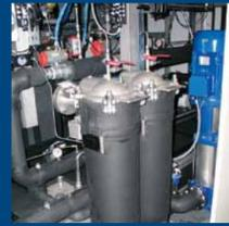
Feinfilter und Pumpe sind wartungsfreundlich hinter einer Schiebetür angeordnet
