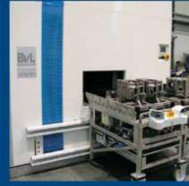
Automatischer Ein- und Austransport des Werkstückes auf zwei Querverschiebetischen
