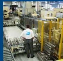
Durchlaufreinigungsanlage mit Umlaufverkettung
