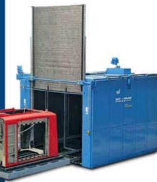
Die Wirkung des „Schmutzschabens“ ist eine Kombination aus der Bewegung des Wasserstrahls und einer großen Menge Wasser zum Abtransportieren der gelösten Verunreinigungen.
