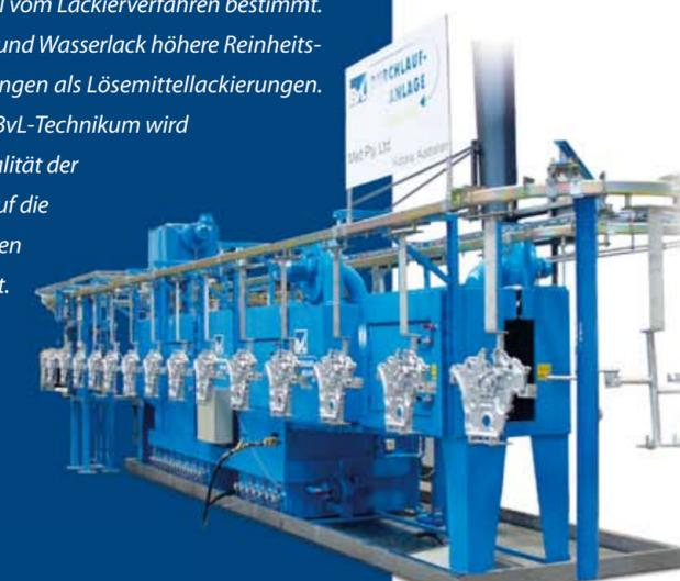
Verfahren wie Entfetten, Phosphatieren, Spülen I, Spülen II und VE-Sprühkranz mit anschließender Abblas- oder Trockenzone sind für uns gängige Problemlösungen. Unsere Anlagen werden neben der reinen Lackiervorbehandlung
