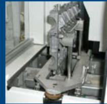
Werkstückträger zum Teiletransport
