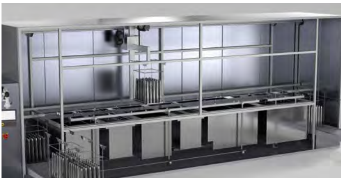
Die Anzahl der Behandlungsstufen ist individuell wählbar und richtet sich nach den erforderlichen Verfahrensschritten zur Erzielung der vorgegebenen Bauteilsauberkeit.
