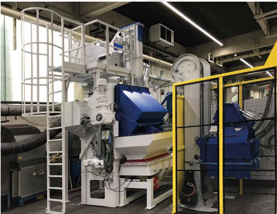
**AGTOS** Trommel-Strahlmaschine vom Typ TS 150 zum Reinigen und Verfestigen von kleinen Tellerfedern
