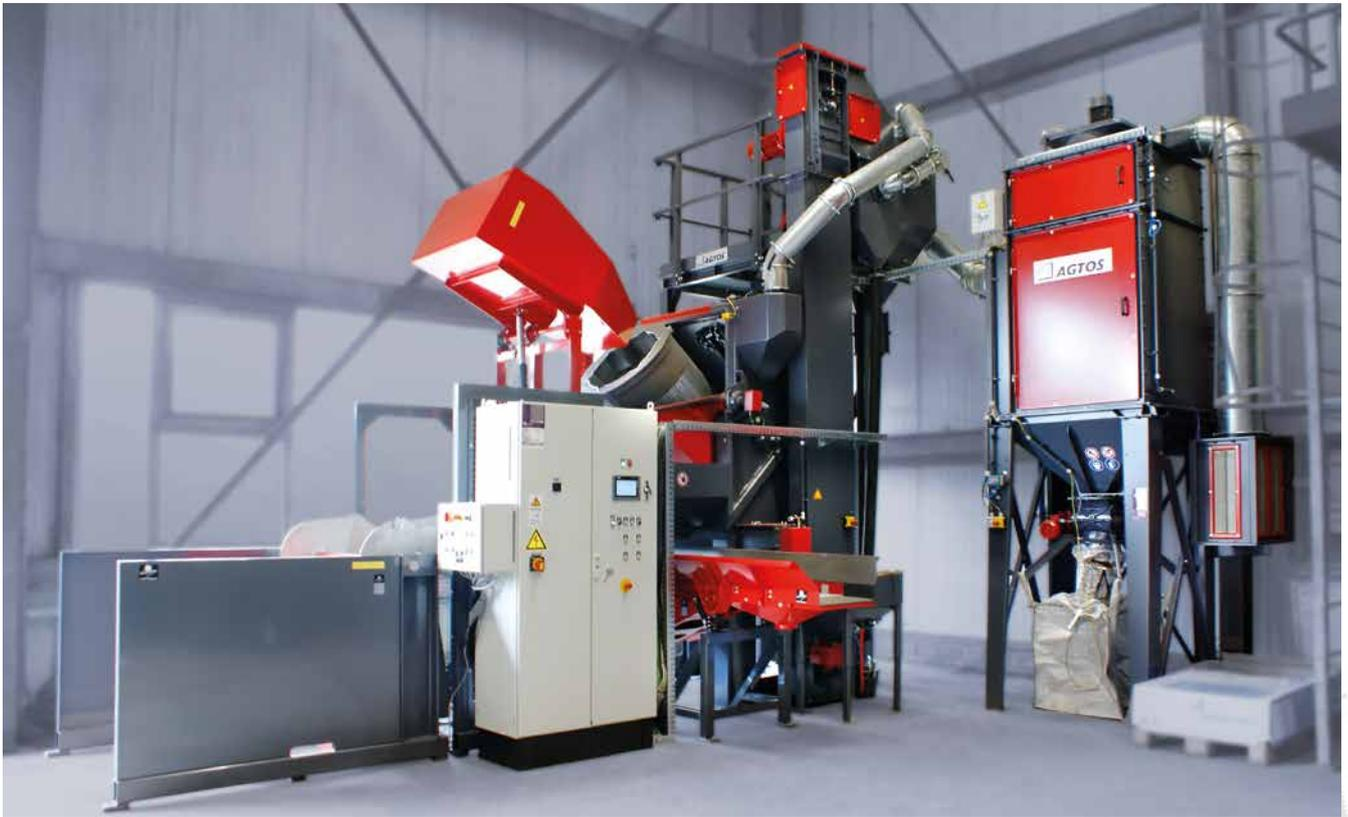
**AGTOS** Trommel-Strahlmaschine vom Typ TS 150 mit Beschicker und Schwingförderrinne
