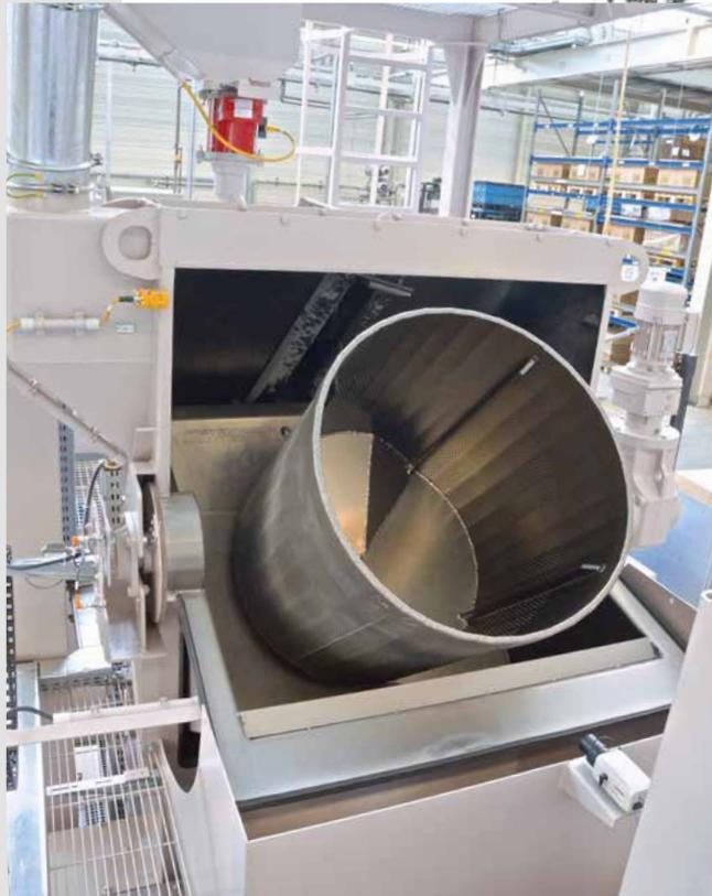
*Trommel-Strahlanlagen werden zur strahl-technischen Bearbeitung der verschiedensten Massenteile eingesetzt.*
