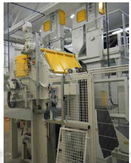
**AGTOS** Trommel-Strahlanlage mit Beschickungseinrichtung und Sicherheitszaun
