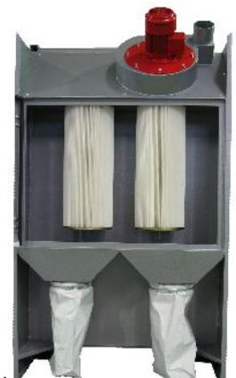
Die kompakte und zugleich leistungsstarke Filteranlage mit einem 0,55 kW Exhaustmotor und dem Doppelfilter mit insgesamt 8 m<sup>2</sup> Filterfläche vereinen nicht nur eine sehr niedrige Bauhöhe, sondern gleichzeitig auch eine überdurchschnittliche Abscheideleistung.
