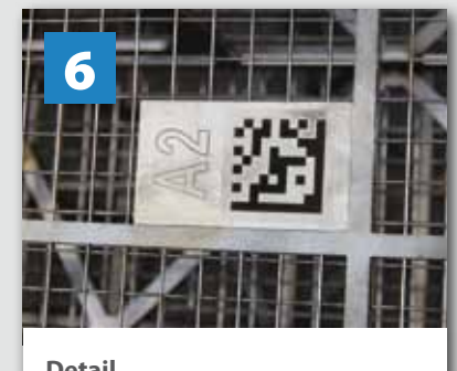
Detail Barcode-Abfrage + Waschprogramm-Hinterlegung
