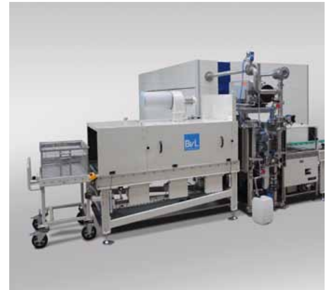
Detail: Niagarawe mit Zubringewagen, Kühltunnel, externer Vakuumtrocknung und Rollenbahn
