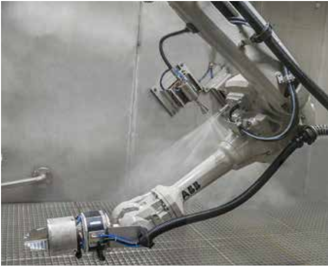
Roboterassistierte Bauteilführung an stationär angeordnete Hochdruck-Wasserwerkzeuge
