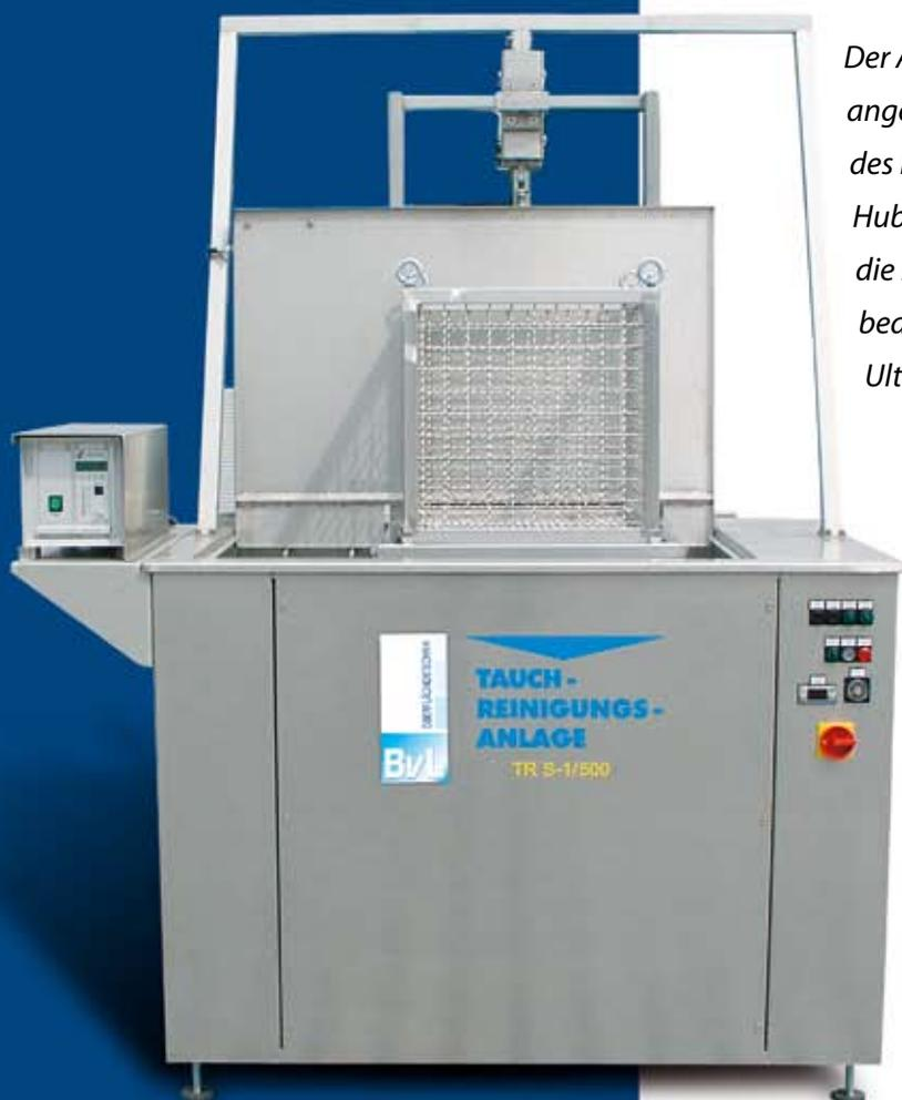
*Der Arbeitstisch wird pneumatisch angehoben und abgesenkt. Unterhalb des Flüssigkeitsspiegels sorgen kurze Hubbewegungen (Oszillation) für die Reinigungswirkung. Dieses kann bedarfsweise durch den Einsatz von Ultraschall verstärkt werden.*
